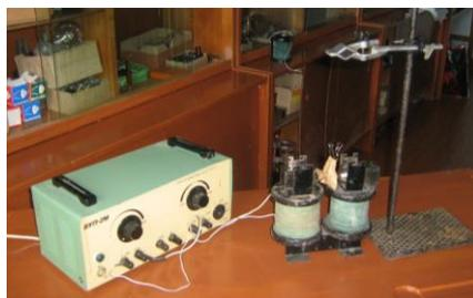
Рис. 1. Установка для обработки семян магнитным полем
