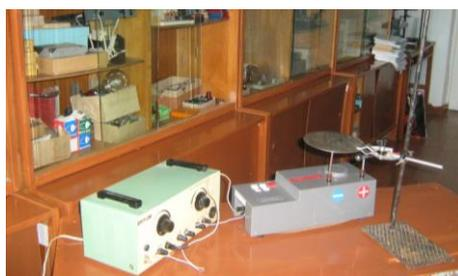
Рис. 2. Установка для обработки семян электрическим полем
